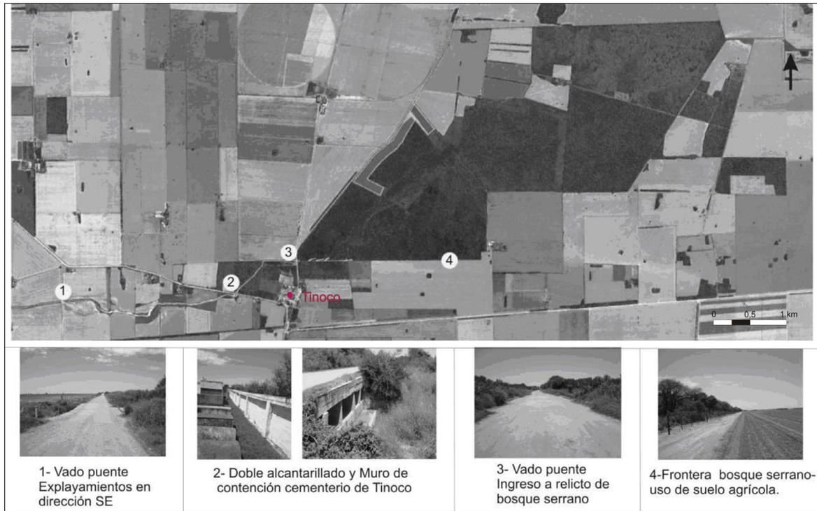
**Figura 5:** Vados puentes realizados para mitigar los efectos de las inundaciones y zona de contacto de usos de suelo agrícola con relicto de bosque nativo
