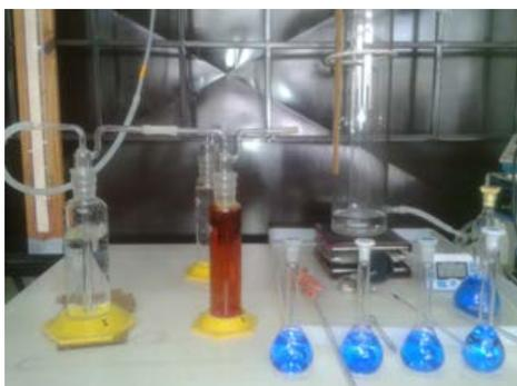
**Figura 5.** Frascos burbujeadores y matraces con índigo, previamente al agregado de agua ozonizada
