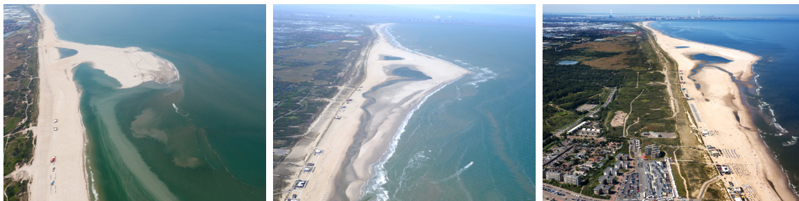
Figura 4.10. Motor de Arena poco después de su colocación en julio del 2011 (izquierda) y su evolución natural con el paso del tiempo: en mayo del 2015 (centro) y julio de 2017 (derecha).
