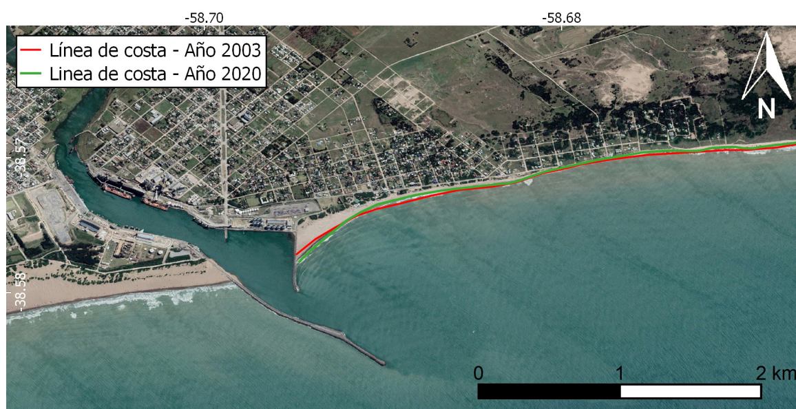
Figura 4.6. Línea de costa en Quequén antes y después de la extensión de la escollera.
