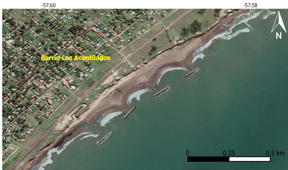
Figura 4.14. Espigones paralelos a la costa - Playa Acantilados, Mar del Plata.
