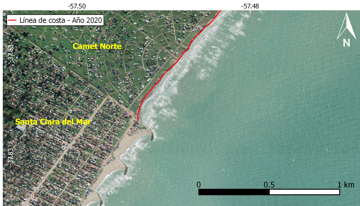
Figura 4.4. Retroceso de la línea de costa en Camet Norte.
